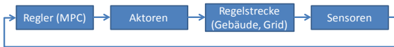
Abbildung 3. Schematische MPC-Regelschleife mit wesentlichen Komponenten des geschlossenen Regelkreises. Regler, Aktoren und Sensoren müssen passend zu den Anforderungen gewählt werden.
